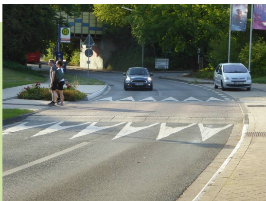
Bild 23: Aufpflasterungen, Verschwenkungen und Verengungen bremsen Verkehr auch ohne Schilder.
